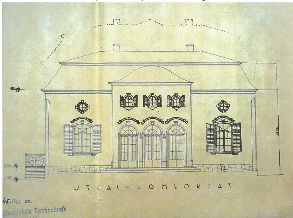
Az utcai és a hátsókerti átalakított homlokzat (az eredeti tetőidom kontúrjának jelzésével)
