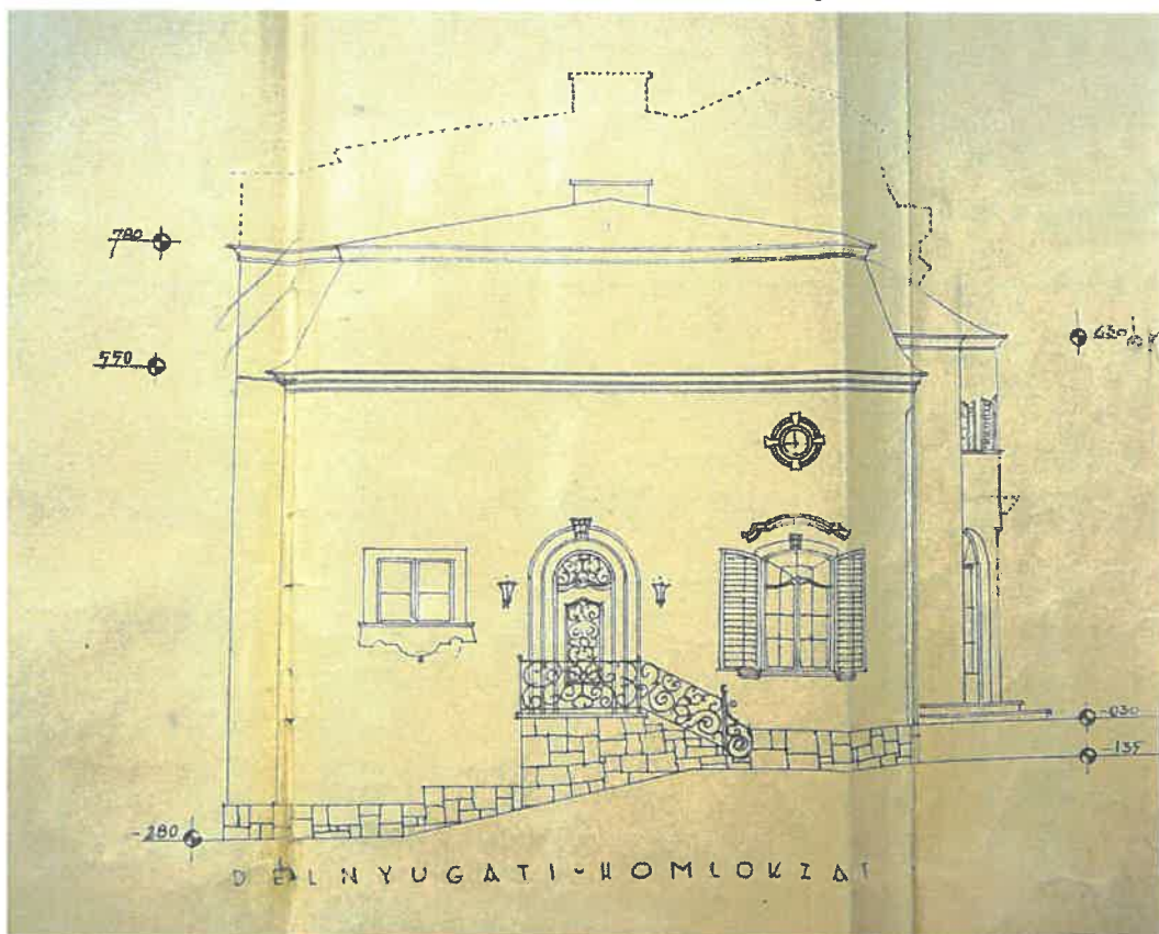
Az oldalhomlokzatok átalakítási tervei (az eredeti tetőidom kontúrjának jelzésével)
