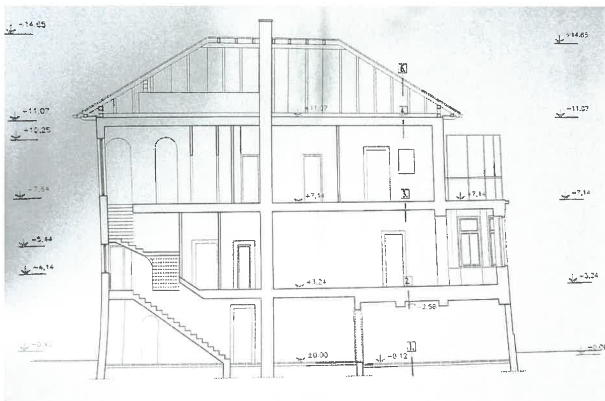
FELMÉRÉSKORI ÁLLAPOT: az emelet alaprajza és a metszet
